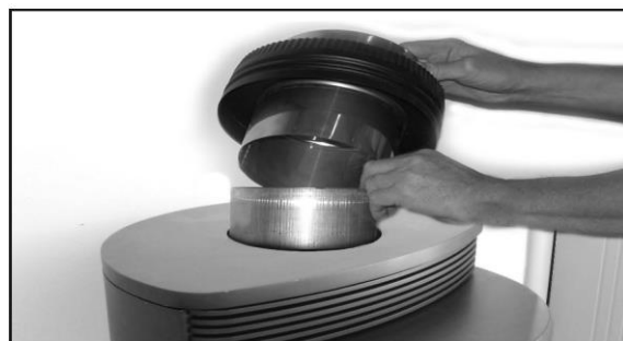
Montera först dit adapterröret enligt bilden ovan. Täta med pannkitt. Placera sedan dit kopplingsstycket, var noggran med att följa skorstensleverantörens anvisningar.
